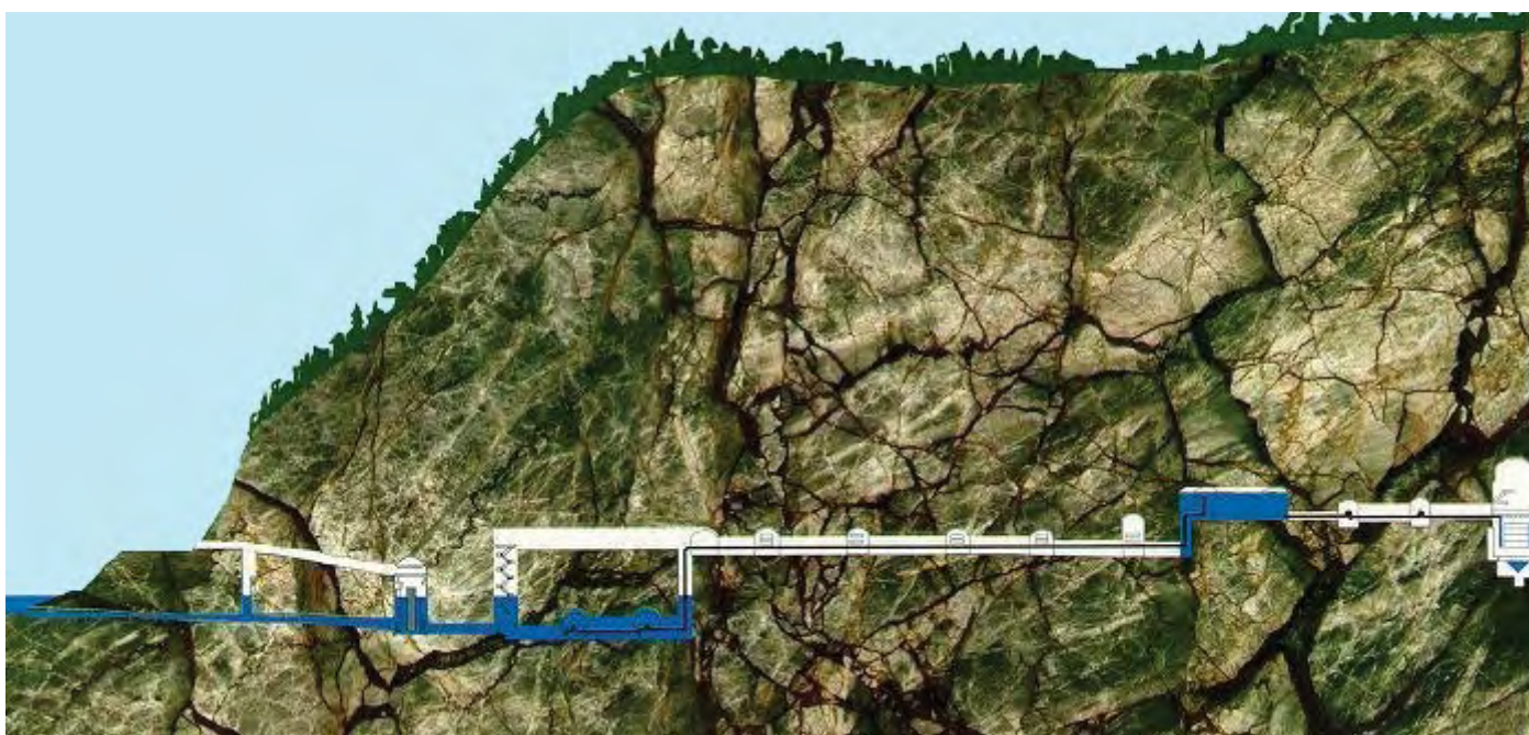
Рис.9 Схема охлаждения реакторов водами Енисея
