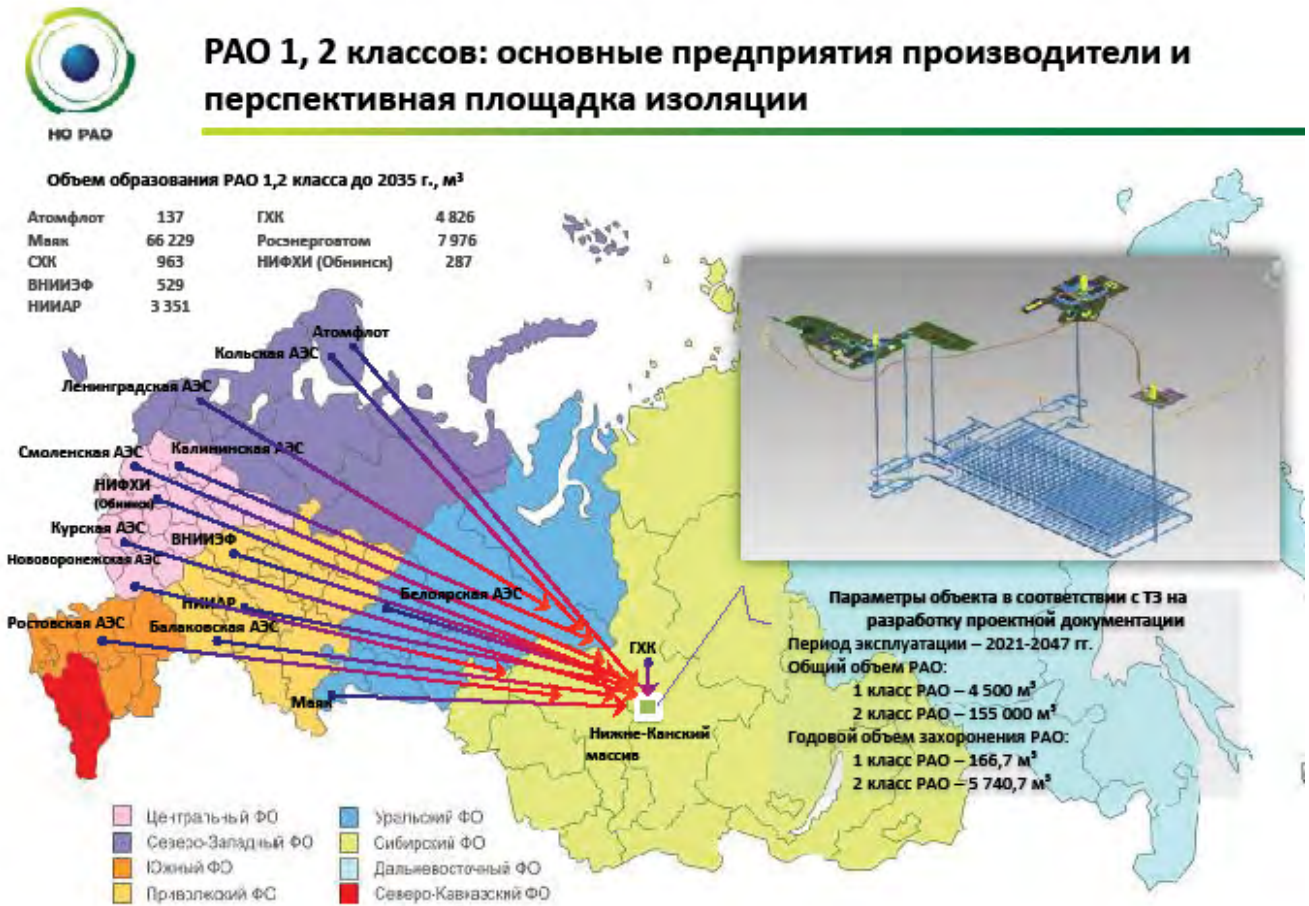
Рис. 31 Концепция Росатома по окончательной изоляции РАО 1 и 2 класса
